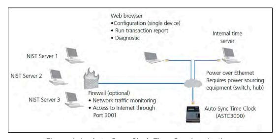
Figure 1-1. Auto-Sync Clock Time Synchronization.
